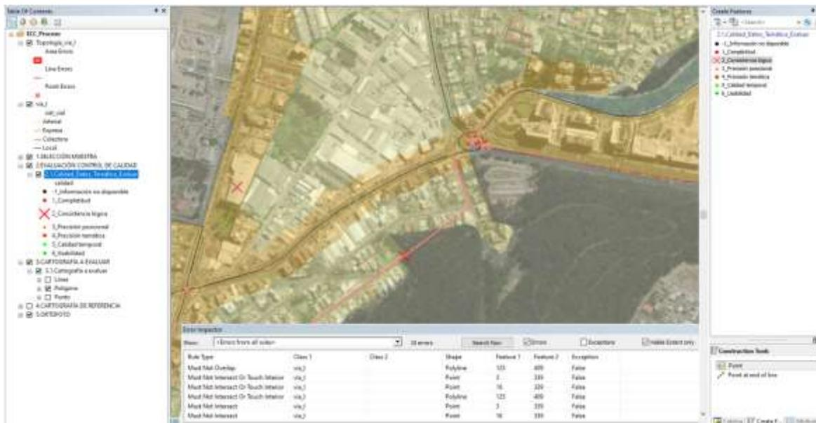
Figura 16. Verificación de errores topológicos registrados en la base de datos de calidad.
